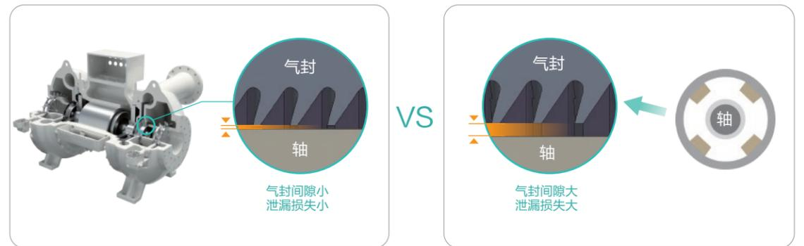
正压液浮超低气封间隙
